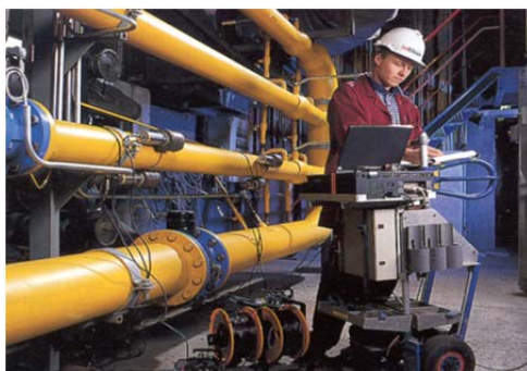
Kuva 28. Kaasuvirtausmittauksen kenttäkalibrointi merkkiainemenetelmällä.
